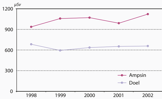
Figuur 13 De achtergrondstraling gemeten op de site van de kerncentrale van Doel, vergeleken met deze te Ampsin, op de Maas, stroomafwaarts van Hoei. Het verschil in dosis (uitgedrukt in \mu\text{Sv} per jaar) tussen beide sites is toe te schrijven aan de geografische variaties in het natuurlijke stralingsniveau en niet aan de aanwezigheid van de kerncentrales, waarvan de milieu-impact verwaarloosbaar is (dit wordt door andere metingen bevestigd). De metingen omvatten enkel de gammacomponent van de aardse en kosmische straling, wat het verschil verklaart met de waarden uit figuur 1.
