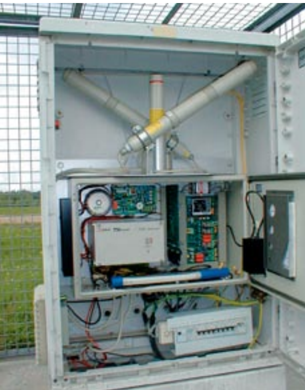
Figuur 3 Atmosferisch meetstation voor de bepaling van de stralingsdosis in de omgeving, met binnenzicht op zijn drie detectoren.
