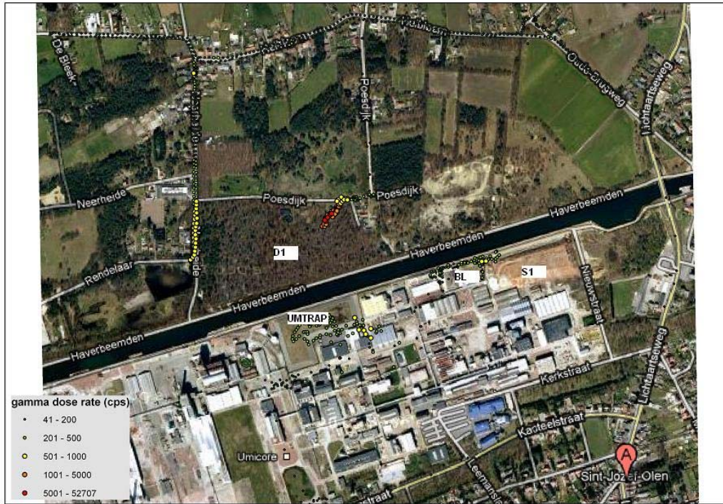
Fig. 8 : rayonnement externe (coups par seconde) à la surface dans la zone d'Olen.
