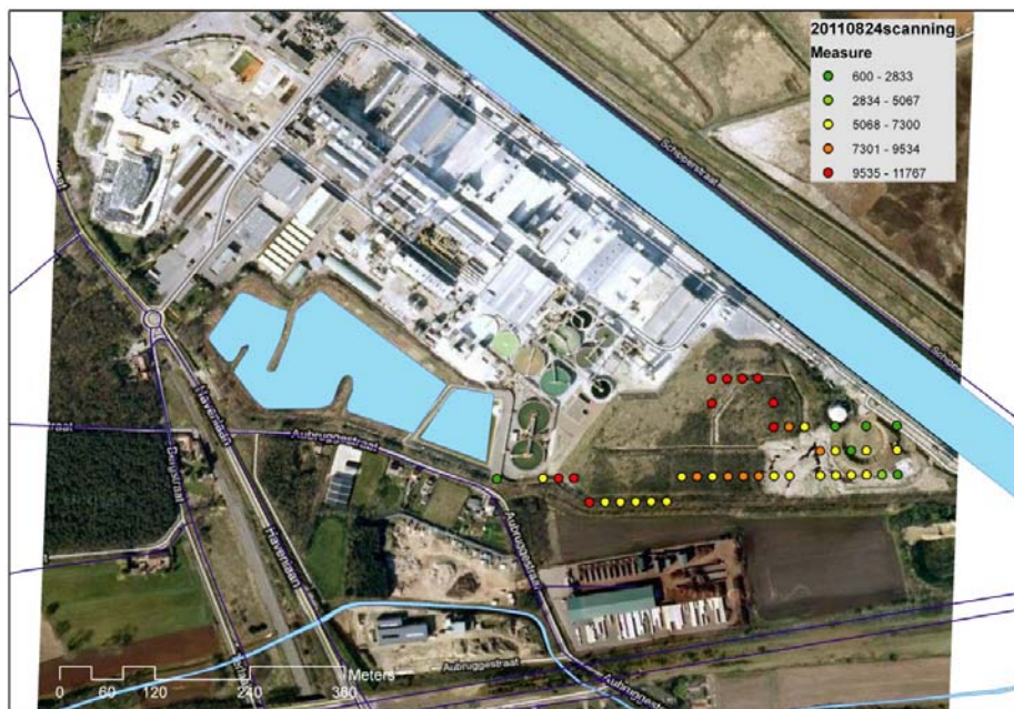
Fig. 3 : mesures de rayonnement gamma (en coups par seconde) à la surface du site de l'entreprise de TESSENDERLO CHEMIE à Ham.
