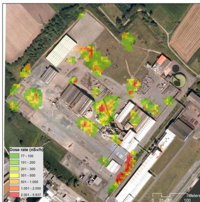
Afb. 9: dosisdebiet aan het oppervlak van de bedrijfsite SADACI nv.
