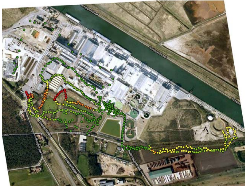
Afb. 4: gammastralingsmetingen (in tellen per seconde) aan het oppervlak van de bedrijfsite van TESSENDERLO CHEMIE in Ham.
